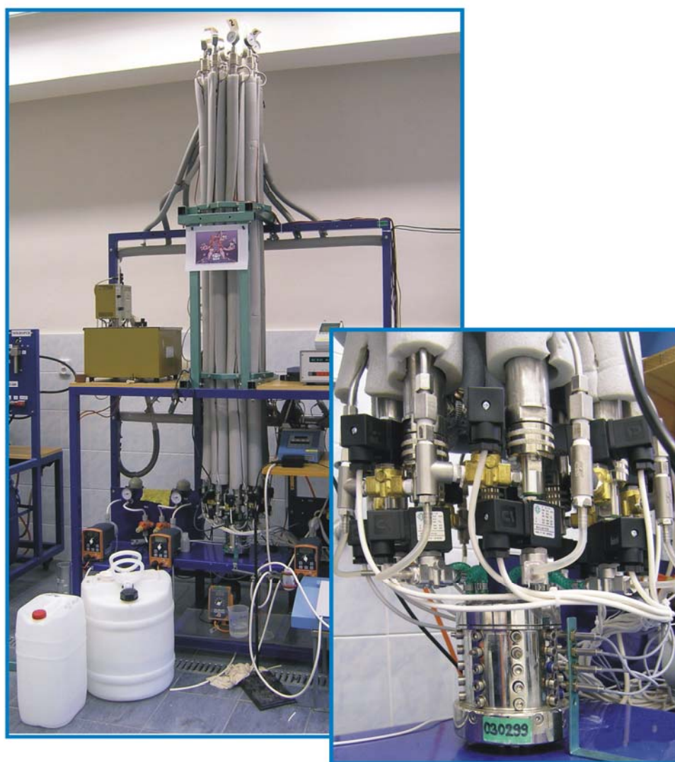
Obr. 1. Celkový pohled na stanici a spodní část kolon s ventilovou hlavou
